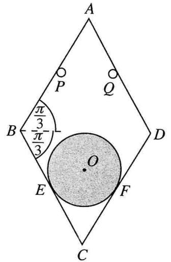
රූපයේ පෙන්වා ඇති පරිදි, රාමුවෙන් හා තැටියෙන් සමන්විත පද්ධතිය සිරස් තලයක සමතුලිතතාවයේ ඇත්තේ එකම තිරස් මට්ටමේ පිහිටි  $P$  හා  $Q$  අවල සුමට නාදැති දෙකක් මගිනි.  $\hat{ABC} = \frac{2\pi}{3}$ ,  $CE = CF = a$  හා  $AOC$  රේඛාව සිරස් බව දී ඇත.  $CD$  මගින්  $BC$  මත  $C$  සන්ධියේදී යොදන ප්‍රතික්‍රියාවේ විශාලත්වය  $\frac{\sqrt{3}W}{2}$  බව පෙන්වා නාදැති දෙක අතර දුර සොයන්න.
