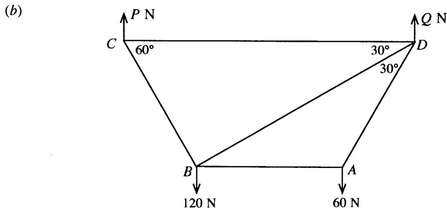
අන්තවලදී සුම්ට ලෙස සන්ධි කරන ලද  $AB$ ,  $AD$ ,  $BC$ ,  $BD$  හා  $CD$  සැහැල්පූ දැඩි පහක රාමු සැකිල්ලක් දී ඇති රුපයෙන් නිරුපණය වේ.  $A$  හා  $B$  හි දී පිළිවෙළින්  $60\text{ N}$  හා  $120\text{ N}$  හාර දරන අතර  $AB$  හා  $CD$  දැඩි තිරස් ව ඇතිව රාමු සැකිල්ල සමතුලිතකාවයේ තබා ඇත්තේ පිළිවෙළින්  $C$  හා  $D$  හි දී යොදු  $PN$  හා  $QN$  සිරස් බල දෙකක් මගිනි. බේ අංකනය යොදීමෙන්, ප්‍රත්‍යාබල සටහනක් අදින්න.
